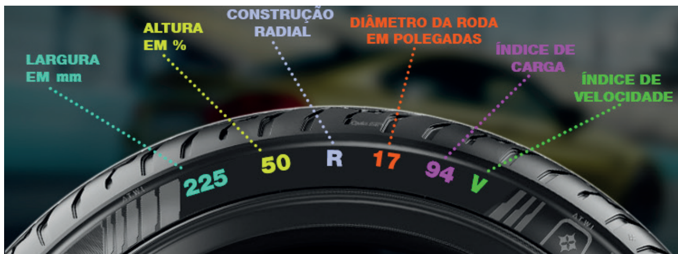
Figura 44 - Pneu com a marcação 225/50R17 94V
